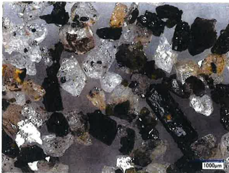
図 2. 2-3 : Aso2014a-B の顕微鏡写真. 500~1000 \mu\text{m} に篩分けた粒子.
