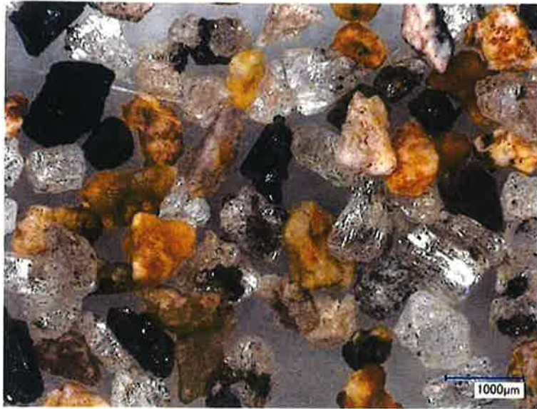
図 2. 2-6 : Aso2014a-E の顕微鏡写真. 500～1000 \mu m に篩分けた粒子.
