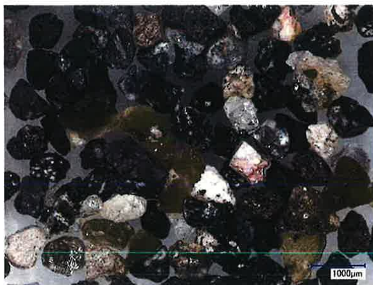
図 2. 2-4 : Aso2014a-C の顕微鏡写真. 500~1000 \mu\text{m} に篩分けた粒子.
